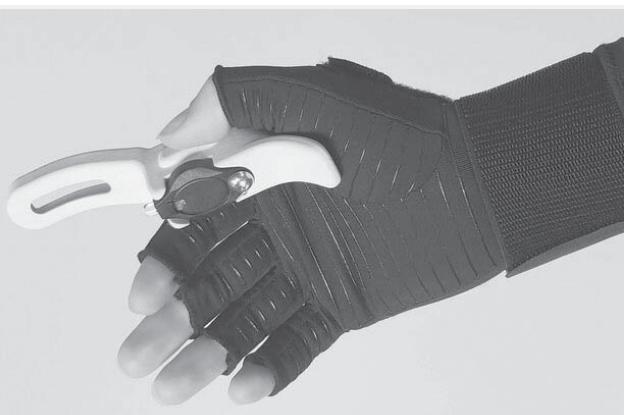
دستکش مذکور مجهز به یک مازول الکترونیکی است که بین شست و انگشت اشاره قرار دارد. این مازول حاوی یک دوربین کوچک و چراغ الای دی است.
